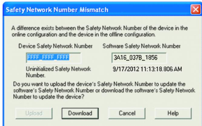
6. 确认相应模块上的网络状态 (NS) 指示灯闪烁，然后单击 OK 设置该设备的 SNN。
