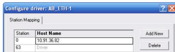
7. 输入 Kinetix 5500 伺服驱动器的 IP 地址。
